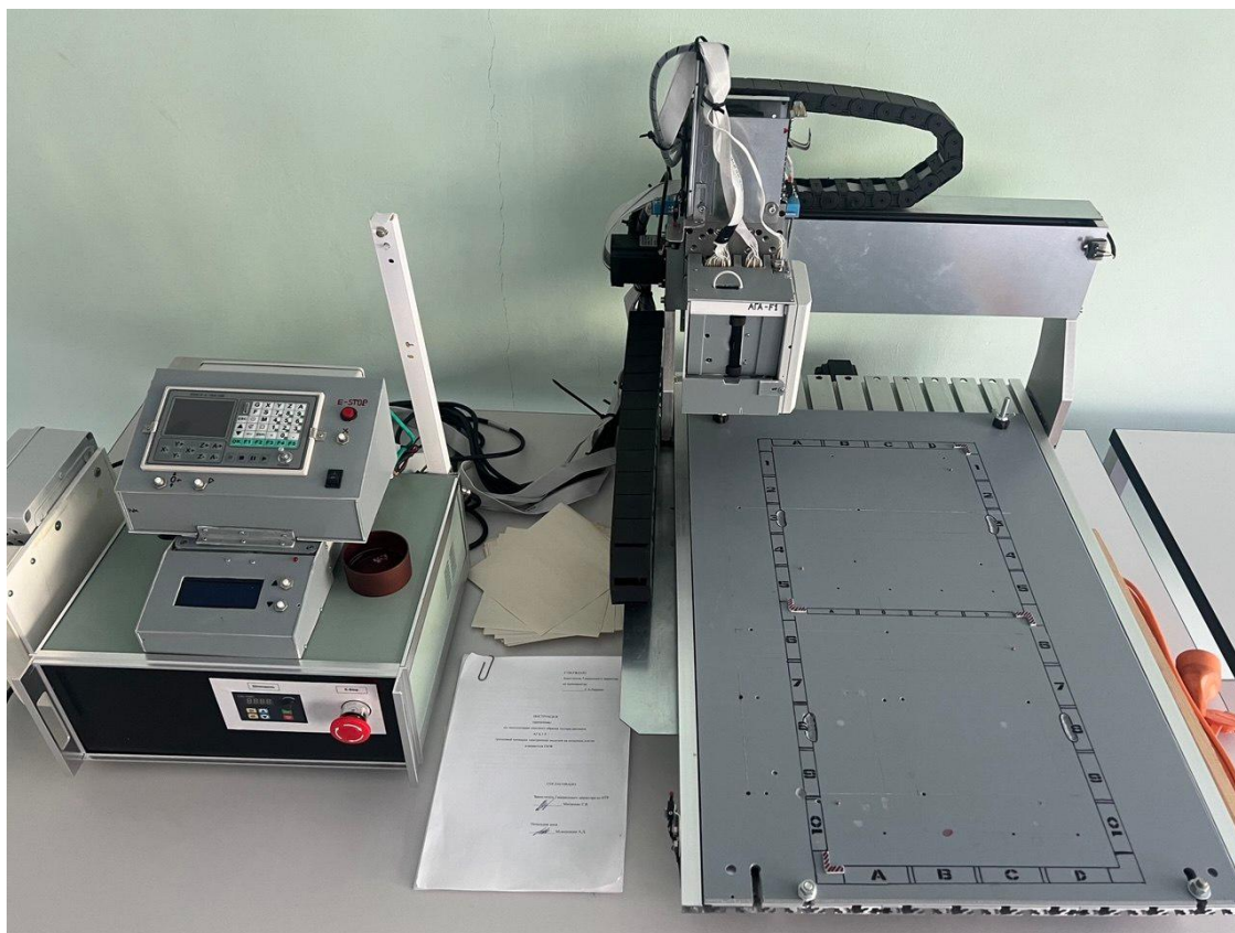
Рисунок 30 – Роботизированный комплекс автоматического программирования и тестирования электронных модулей на печатных платах
