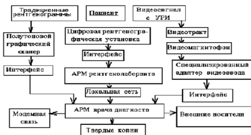
Рисунок 2.4 — Принципиальная схема взаимодействия элементов системы получения, обработки, хранения и передачи рентгеновских диагностических изображений [26]
