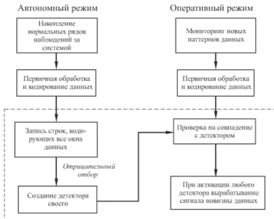
Рисунок 3 – Схема функционирования системы обнаружений аномалий, использующей принципы иммунитета
