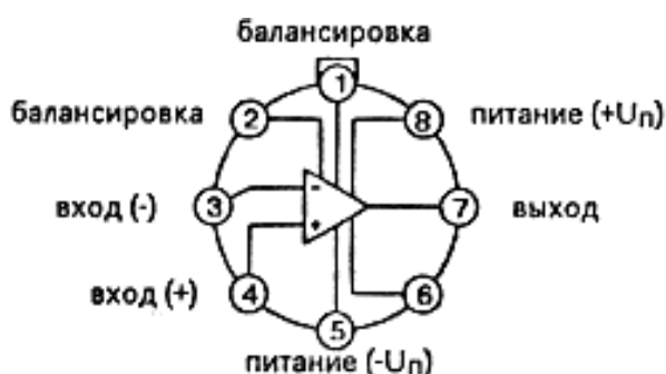
Рисунок 2.6 – Цоколевка корпуса 301.8-2 К140УД17
