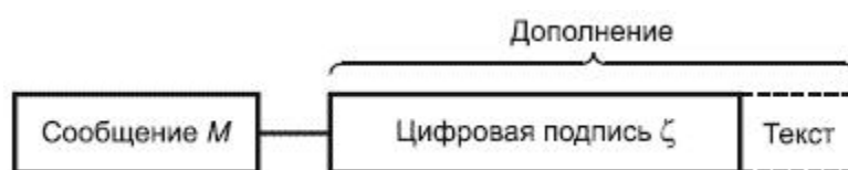
Рисунок 1.5 – Схема подписанного сообщения в соответствии с ГОСТ Р 34.10 – 2012
