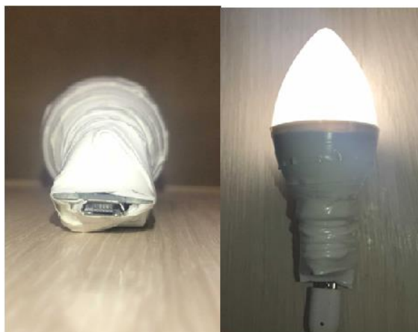
Рис. 9. Светодиодная лампочка с питанием от USB
