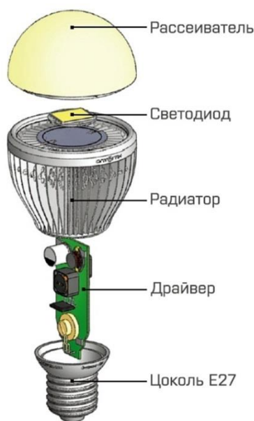
Рис. 10. Строение светодиодной лампочки
