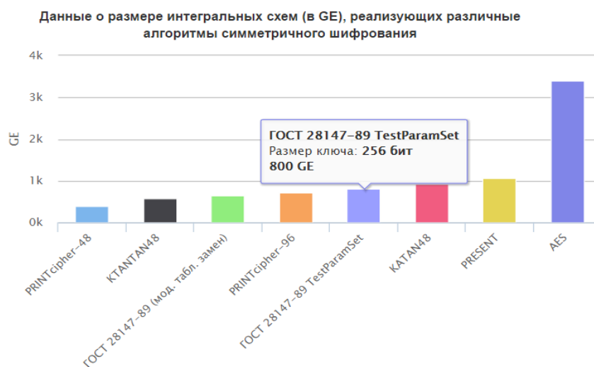
Рисунок 10 – Данные, представленные компанией Крипто-Про о размере интегральных схем, реализующие различные алгоритмы симметричного шифрования
