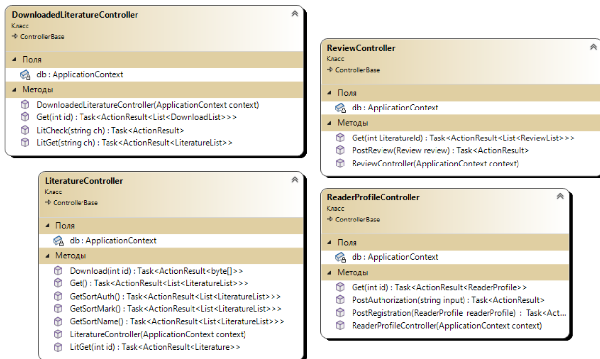
Рисунок 32 – Диаграмма классов серверной части (слой контроллеров)
