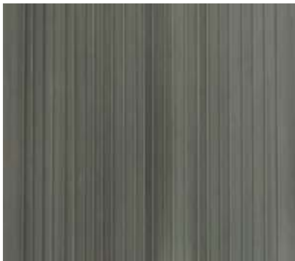
Рисунок 11 – Расположение волокон при армировании сплава ВТ1-0 стальной проволокой марки Ст3
