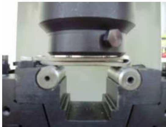
Рисунок 8 – Испытание образцов композиционного материала системы «титан-сталь» до соприкосновения сторон
