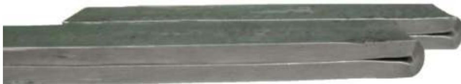
Рисунок 9 – Внешний вид армированного композиционного металлического материала системы «алюминий -медь» после испытания до соприкосновения сторон
