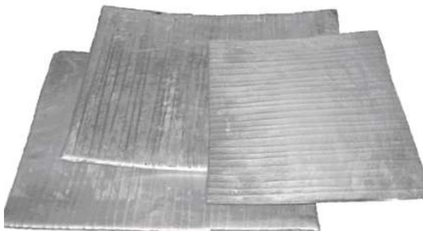
Рисунок 13 – Листовой полуфабрикат армированного композиционного материала на основе АМг5М
