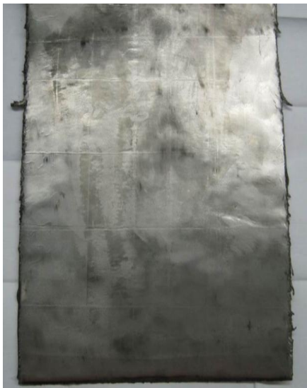
Внешний вид композиционного материала с матрицей из сплава ВТ1-0, полученного на рациональных режимах
