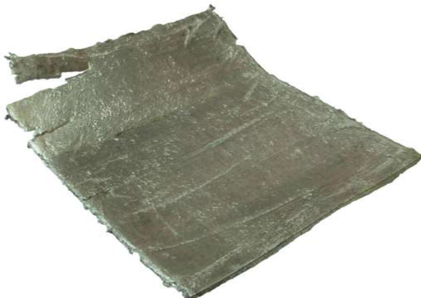
Рисунок 12 – Разрушение образца при сварке взрывом на форсированных режимах
