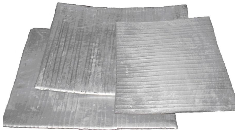
Внешний вид композиционного материала с матрицей из сплава АМг5М, полученного на рациональных режимах
