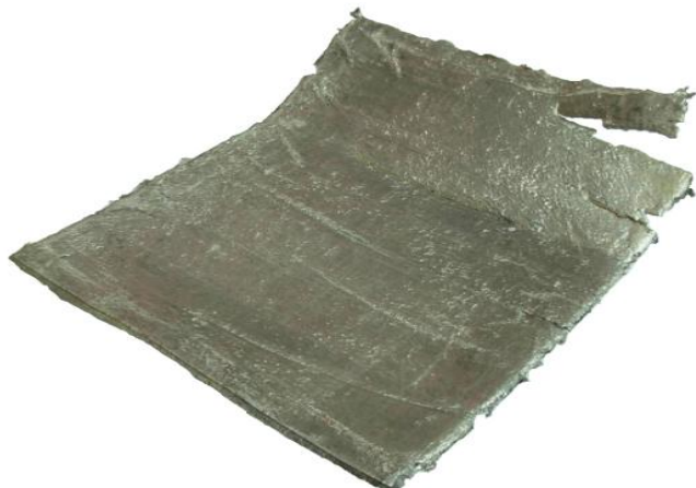
Разрушение образца при сварке взрывом на форсированных режимах
