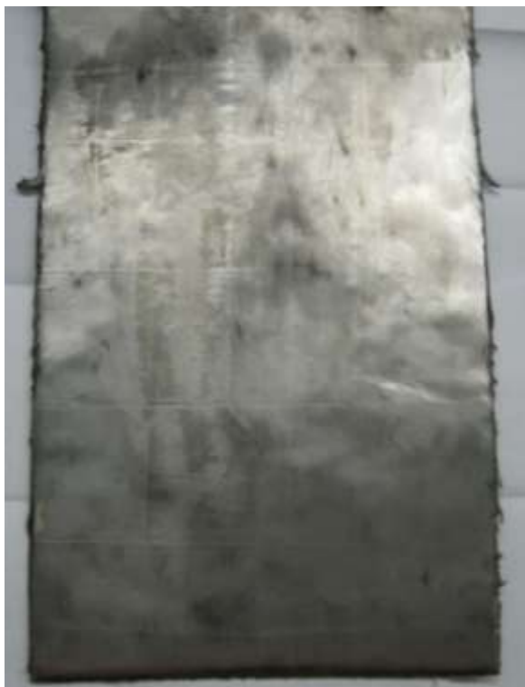
Рисунок 14 – Листовой полуфабрикат армированного композиционного материала на основе ВТ1-0
