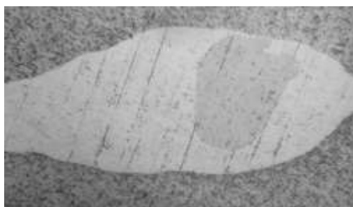
Рисунок 10 – Микроструктура армирующих волокон меди после сварки взрывом: режимы сварки 9 и 10 ( \times 100 )
