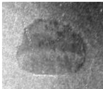
Рисунок 10 – Микроструктура армирующих волокон меди после сварки взрывом: режимы сварки 9 и 10 ( \times 100 )
