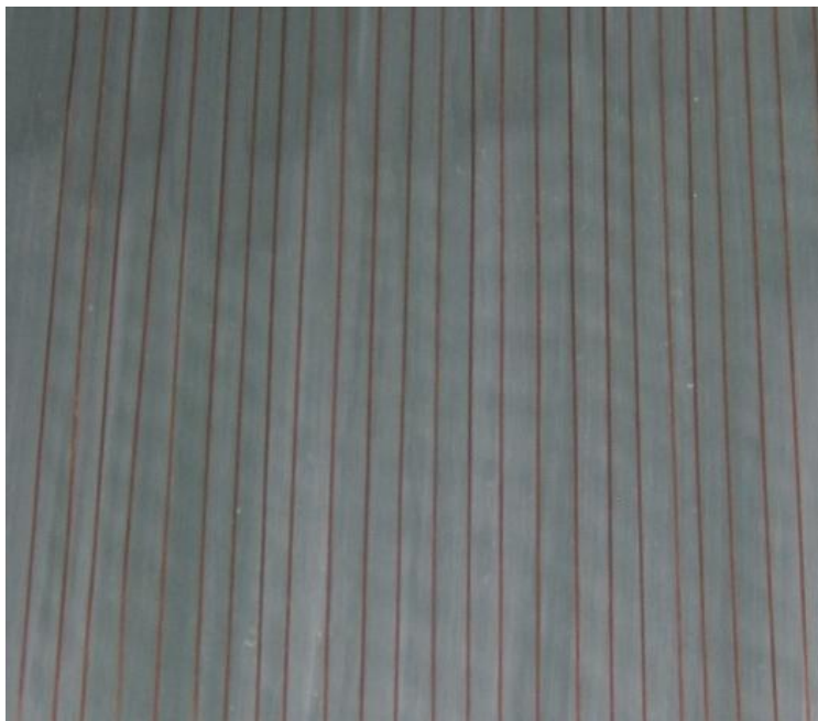
Расположение волокон при армировании сплава АМг5М медной проволокой марки М1
