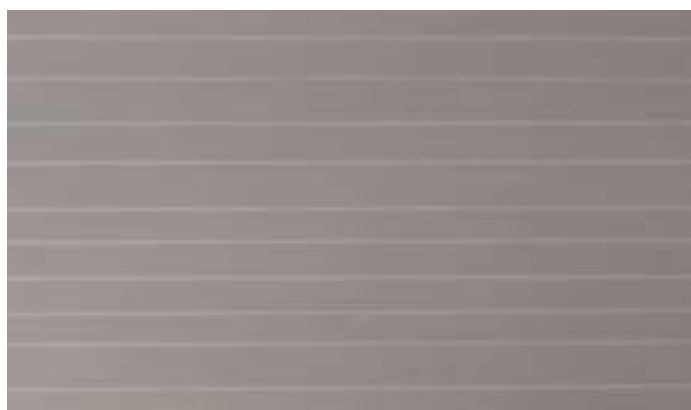
Рисунок 15 – Рентгенографический снимок образца армированного композиционного материала
