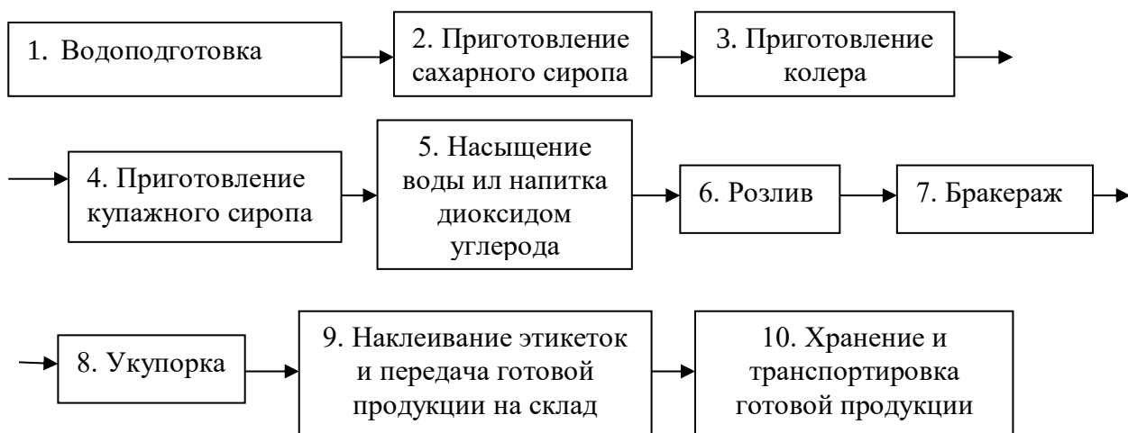
Рисунок 2.2 - Технологическая схема производства и розлива безалкогольных напитков
