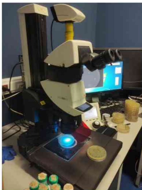
Рисунок 8. Флуоресцентный стереомикроскоп Leica M205FA
