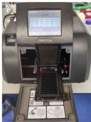
Рисунок 10. Планшетный анализатор Modulus II Microplate Reader
