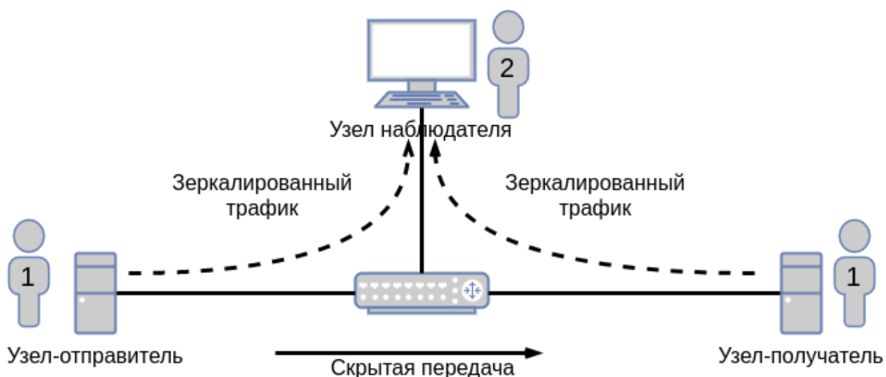
Рисунок 8 — Структура аппаратно-программного комплекса для исследования способов скрытой передачи информации в компьютерных сетях
