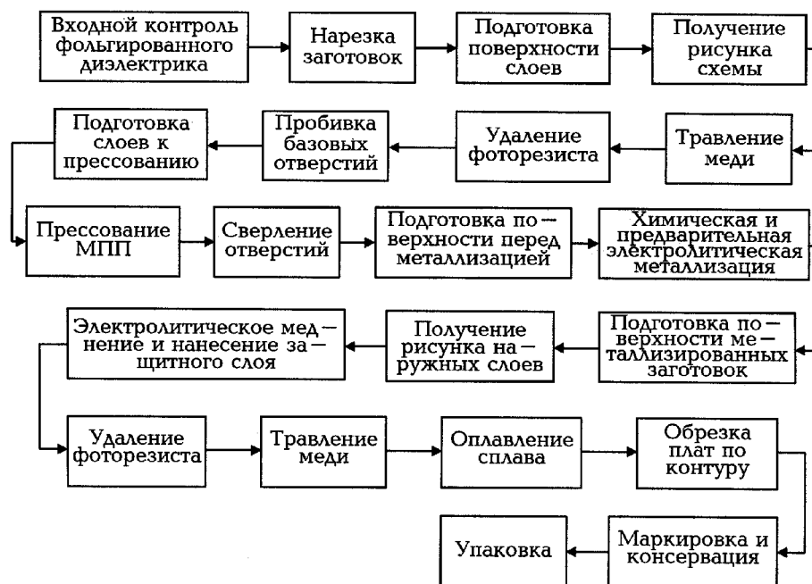
Рисунок 2.3 Схема типового технологического процесса изготовления МПП методом металлизации сквозных отверстий
