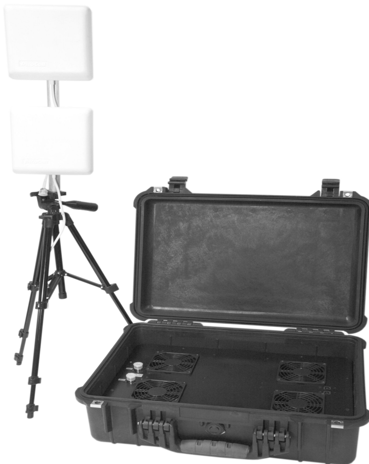
Рисунок 2 - Устройство блокирования беспроводных цифровых каналов радиосвязи «Тарантул»
