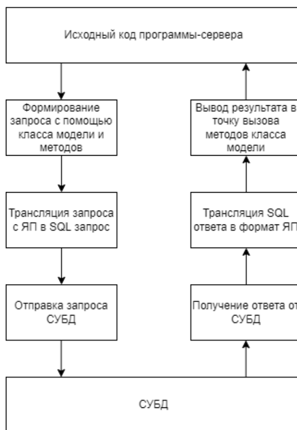
Рисунок 2 – Схема запроса к БД через SQLAlchemy ORM
