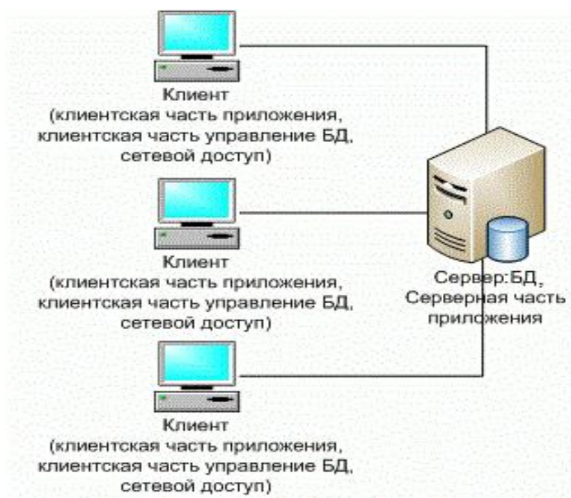
Рисунок 12 – Двухуровневая архитектура «клиент-сервер»
