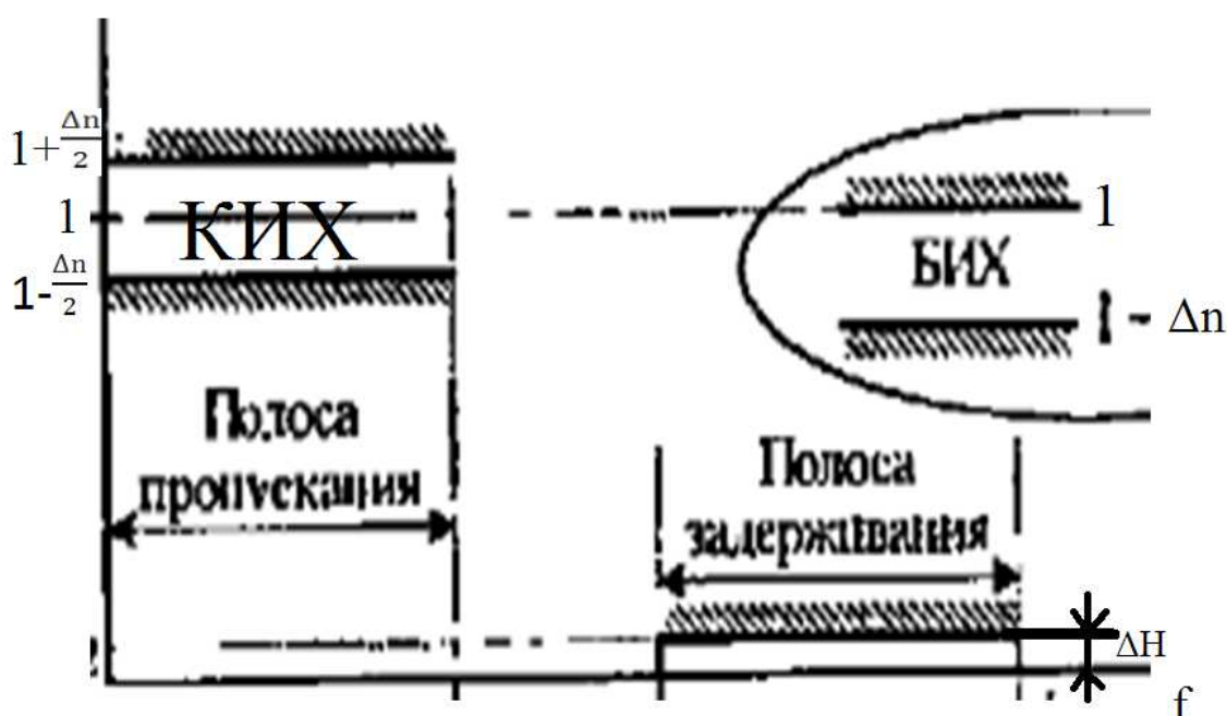
Рисунок 3 – Неравномерность АЧХ фильтров с КИХ и БИХ
