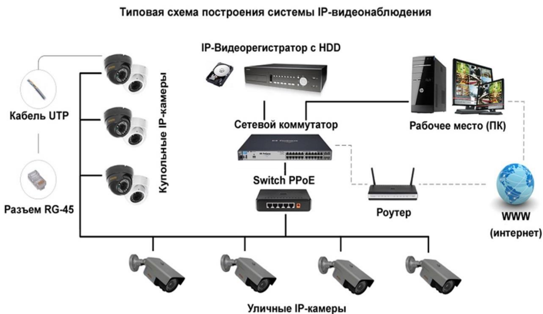
Рисунок 5 – Схема IP видеонаблюдения
