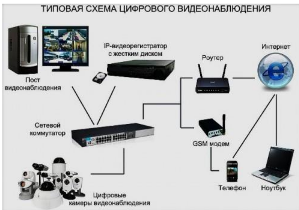
Рисунок 4 – Схема цифрового видеонаблюдения
