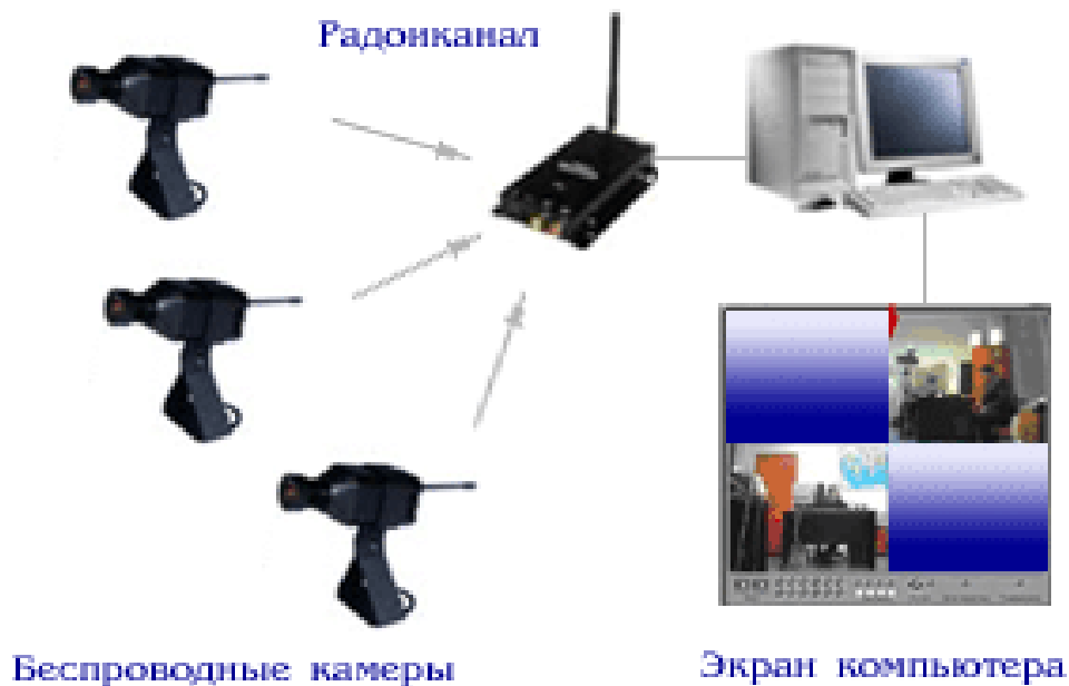
Рисунок 6 – Схема беспроводных систем видеонаблюдения
