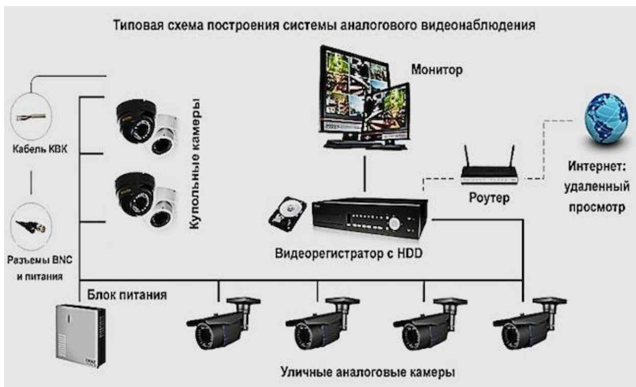
Рисунок 2 – Схема системы аналогового видеонаблюдения
