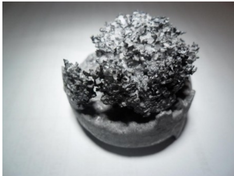
Рисунок 3.2 – Непропитка сыпучего наполнителя для различных значений коэффициента гравитации: а) K=129 ; б) K=145
