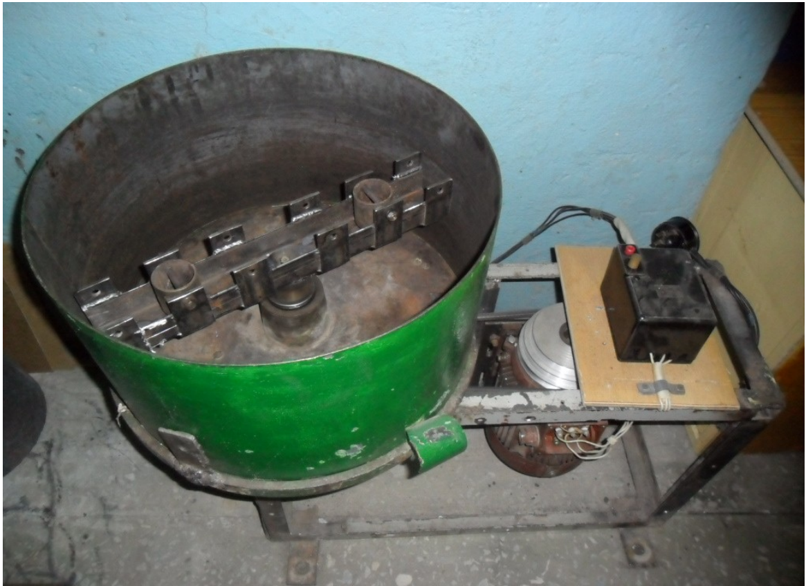
Рисунок 2.6 – Внешний вид центробежной установки
