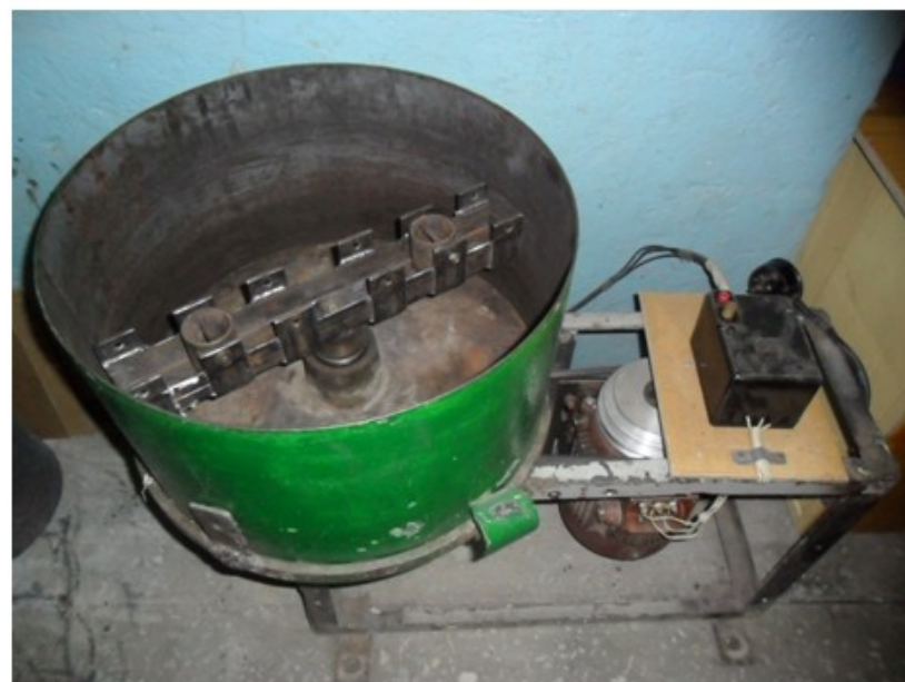
Рисунок 2 – Внешний вид центробежной установки
