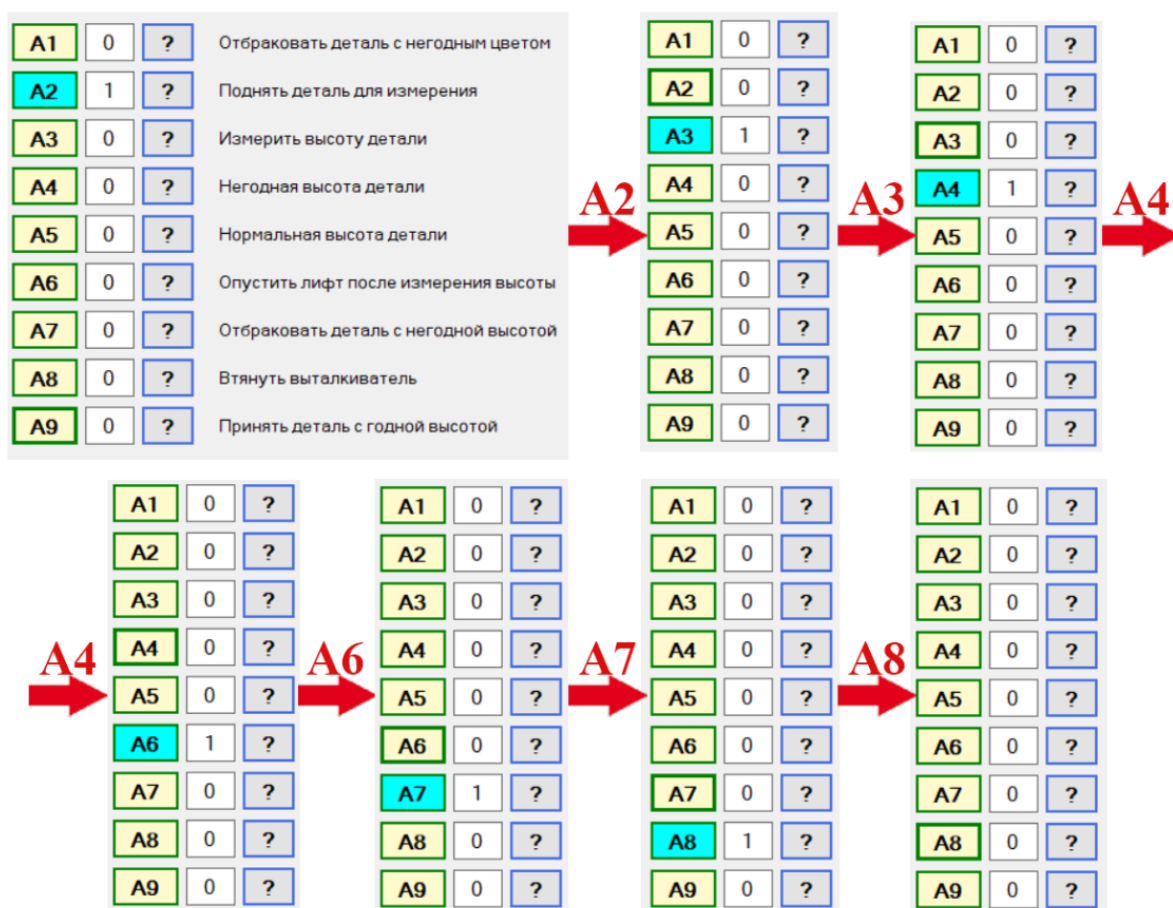
Рисунок 3.14 – Визуализация динамики функционирования модели тестирующей станции (сценарий «нормальный цвет, негодная высота»)
