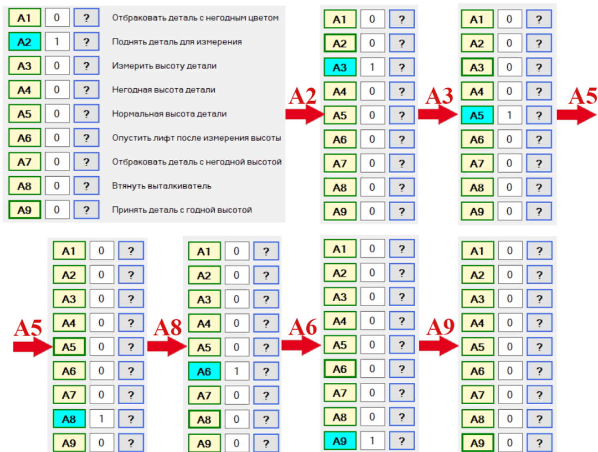
Рисунок 3.15 – Визуализация динамики функционирования модели тестирующей станции (сценарий «нормальный цвет, нормальная высота»)
