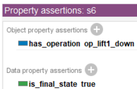
Рисунок 2.13 – Пример описания состояния s6 в системе Protégé
