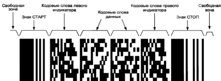
Рисунок 1 – Структура символа штрихового кода PDF-417 [3]
