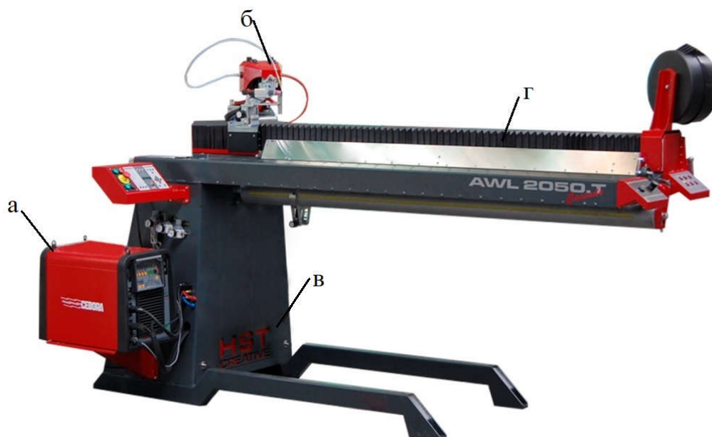
Рисунок 12 – Стенд для сварки продольных швов, а – сварочный автомат; б – автоматическая сварочная головка; в – колонна; г – прижимная центровочная планка
