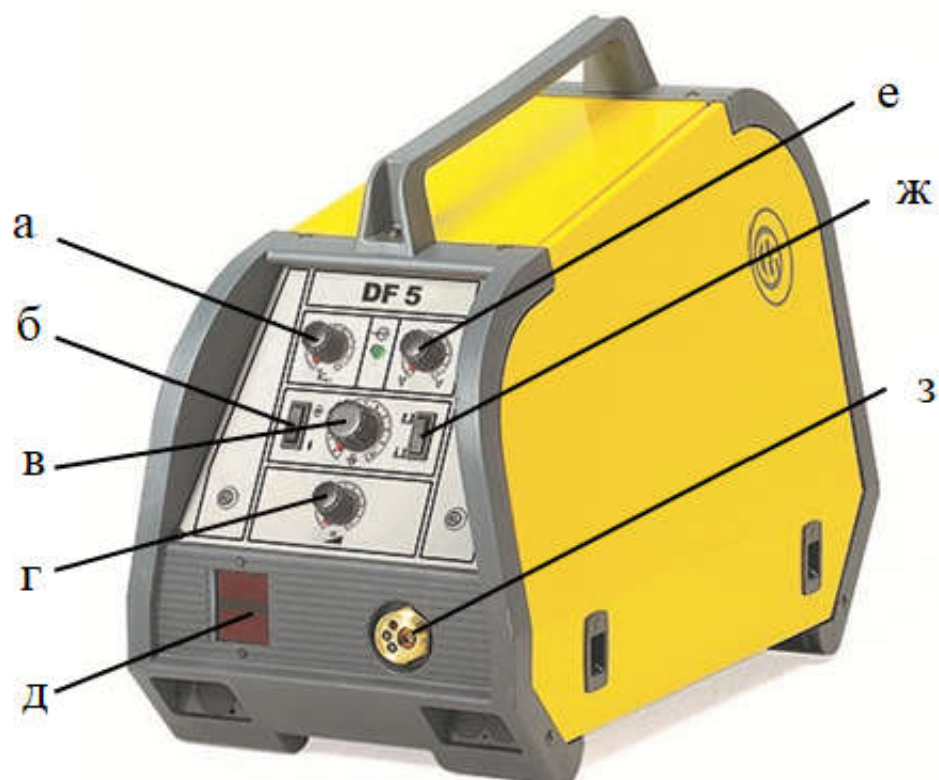
Рисунок 20 – Подающий механизм DF – 5 : а – регулировка плавного старта; б – подача газа / заправка проволоки; в – регулировка сварочного тока; г – регулировка напряжения; д – цифровой амперметр / вольтметр; е – регулировка Burn Back ; ж – переключение между режимами работы; з – евроразъём для сварочной горелки
