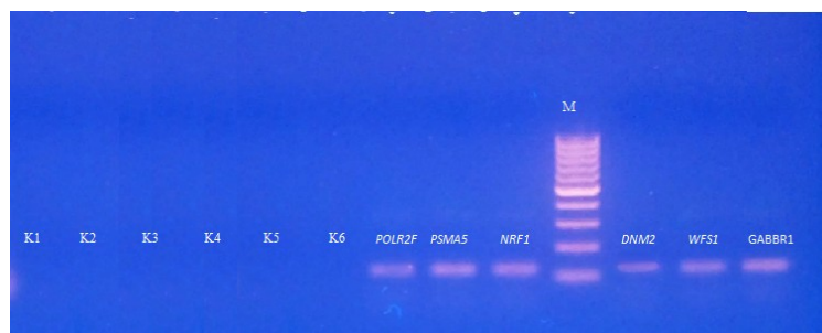
Рисунок 3. Горизонтальный ЭФ в агарозном геле. к1-к6: отрицательные контроли (цифрами 1-6 обозначены гены POLR2F , PSMA5 , NRF1 , DNM2 , WFS1 , GABBR1 соответственно). Буквой М обозначен ДНК-маркер.
