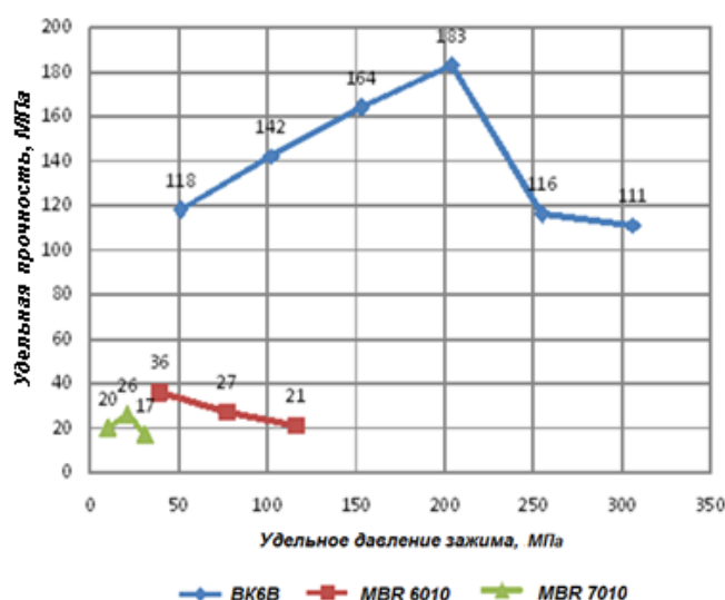
Рис. 3 - Зависимость давления разрушения пластин MBR 6010, MBR 7010 и ВК6В от давления зажима
