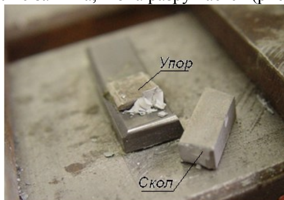
Рис. 4. Скол испытуемой пластины по кромке задней грани в зоне зажима
