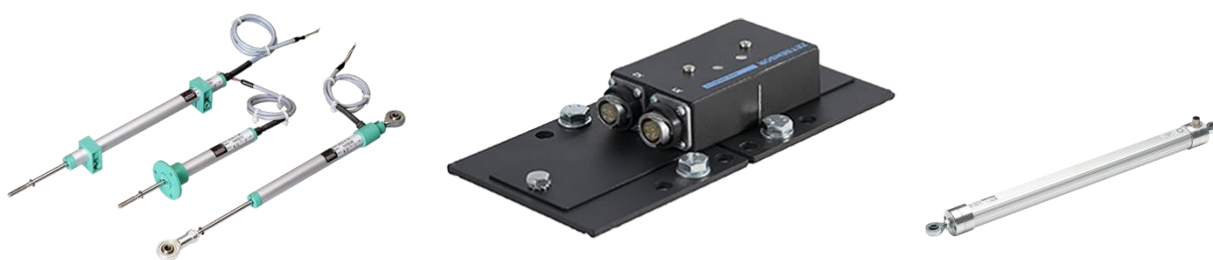
Рис. 4. Датчики измерения ширины раскрытия трещин
