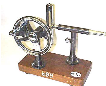
Рис. 6. Макет синусного механизма (а) и схема (б)
