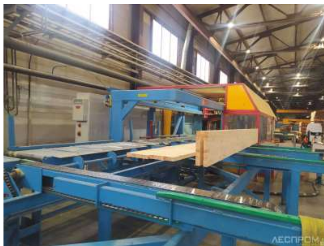
Рис.2, а. Производство МНМ-панелей для малоэтажного деревянного домостроения. Республика Коми, лесопромышленная компания «Лузалес»
