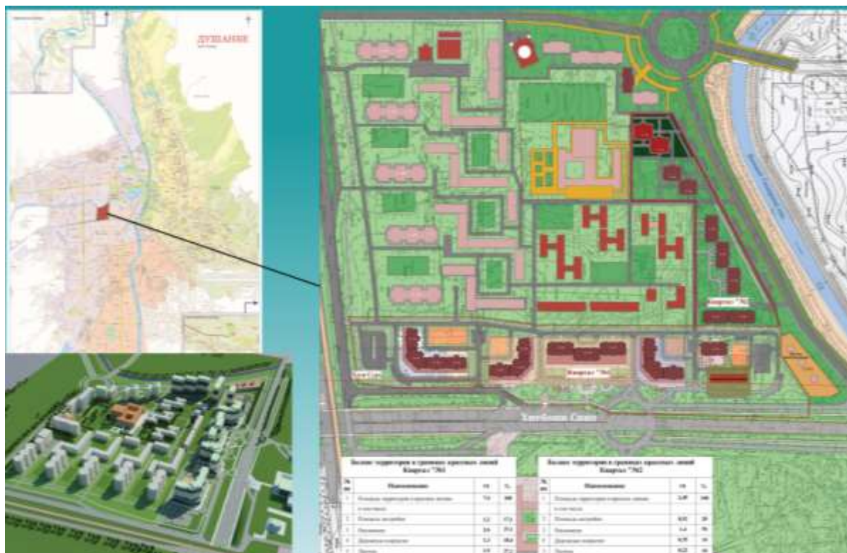
Рисунок 1. Пример Проекта Детальной Планировки (ПДП) в г. Душанбе по проспекту Абуали ибн Сино, с нанесением красной линии и линии застройки, расчётом технико-экономических показателей ТЭП. Автор проекта проектный институт ОАО «Душанбешахрсоз» г. Душанбе (личный архив)
