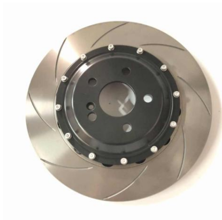
Рисунок 4 – Щелевой/рифлёный тормозной диск
