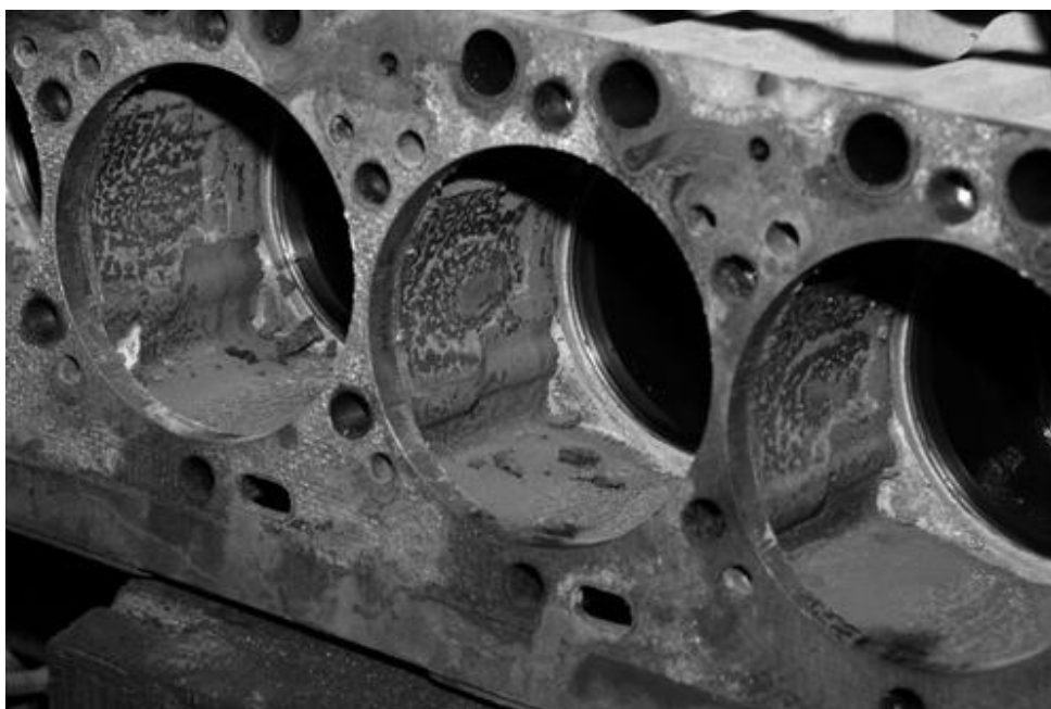
Рисунок 1 – коррозия в блоках цилиндров ДВС
