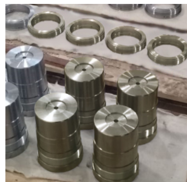
Рис. 3. Плунжеры с покрытием нитрида титана (а) [10], детали насосов с нитрид титановым покрытием с ассистированием ПИНК (б), покрытие \text{CrNiTiZrCu} (в)
