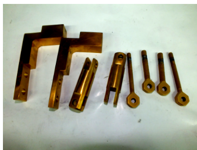
Рис. 3. Плунжеры с покрытием нитрида титана (а) [10], детали насосов с нитрид титановым покрытием с ассистированием ПИНК (б), покрытие \text{CrNiTiZrCu} (в)
