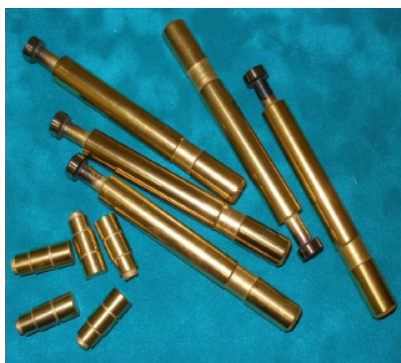
Рис. 3. Плунжеры с покрытием нитрида титана (а) [10], детали насосов с нитрид титановым покрытием с ассистированием ПИНК (б), покрытие \text{CrNiTiZrCu} (в)
