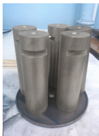
Рис. 1. Соединительный штифт приводного диска локомотива (а) и его чертеж (б)
