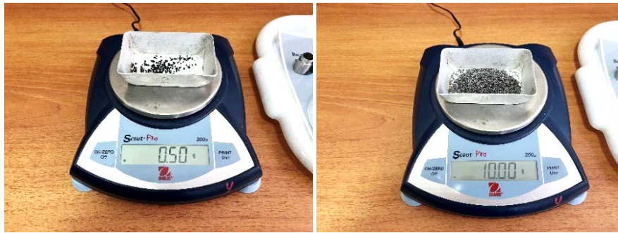
Рис. 5. Подготовка воспламенителя и порохового заряда
