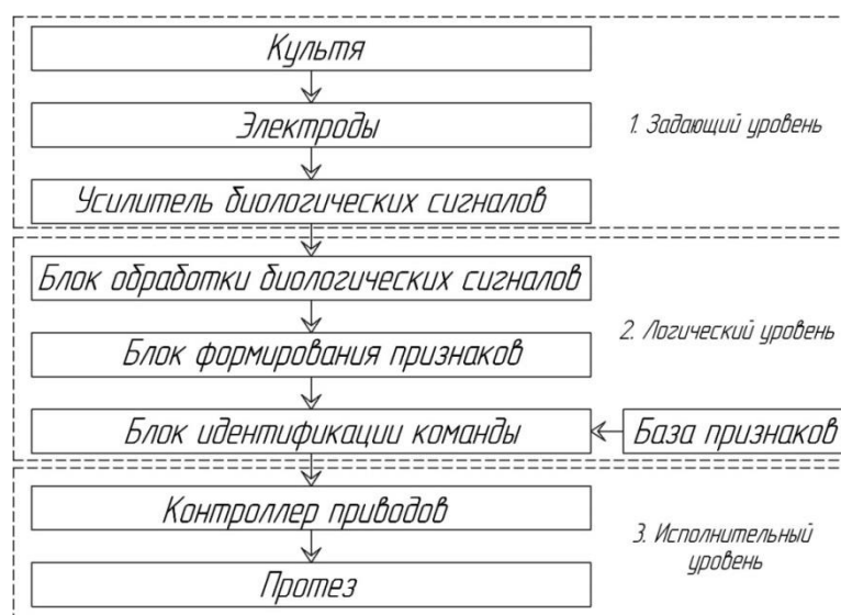
Рис. 1. Структурная схема системы управления бионическим протезом
