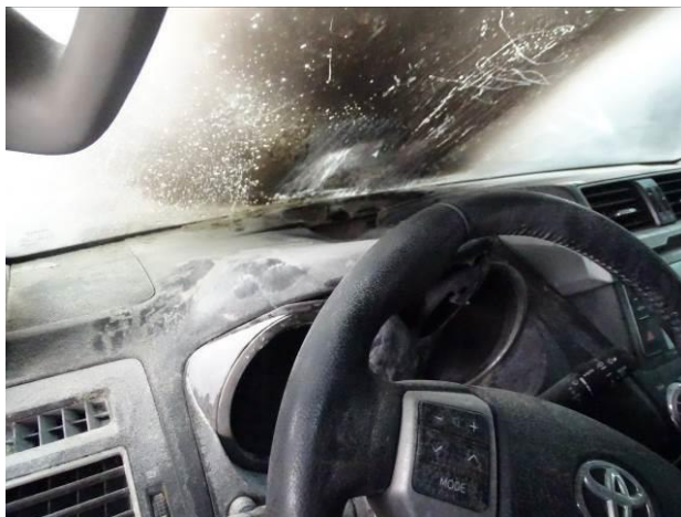
Рис. 1. Копоть на лобовом стекле
