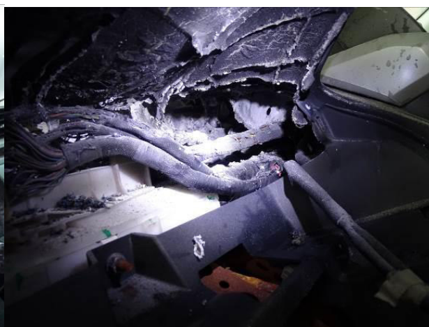
Рис. 2. Прогар панели щитка приборов
