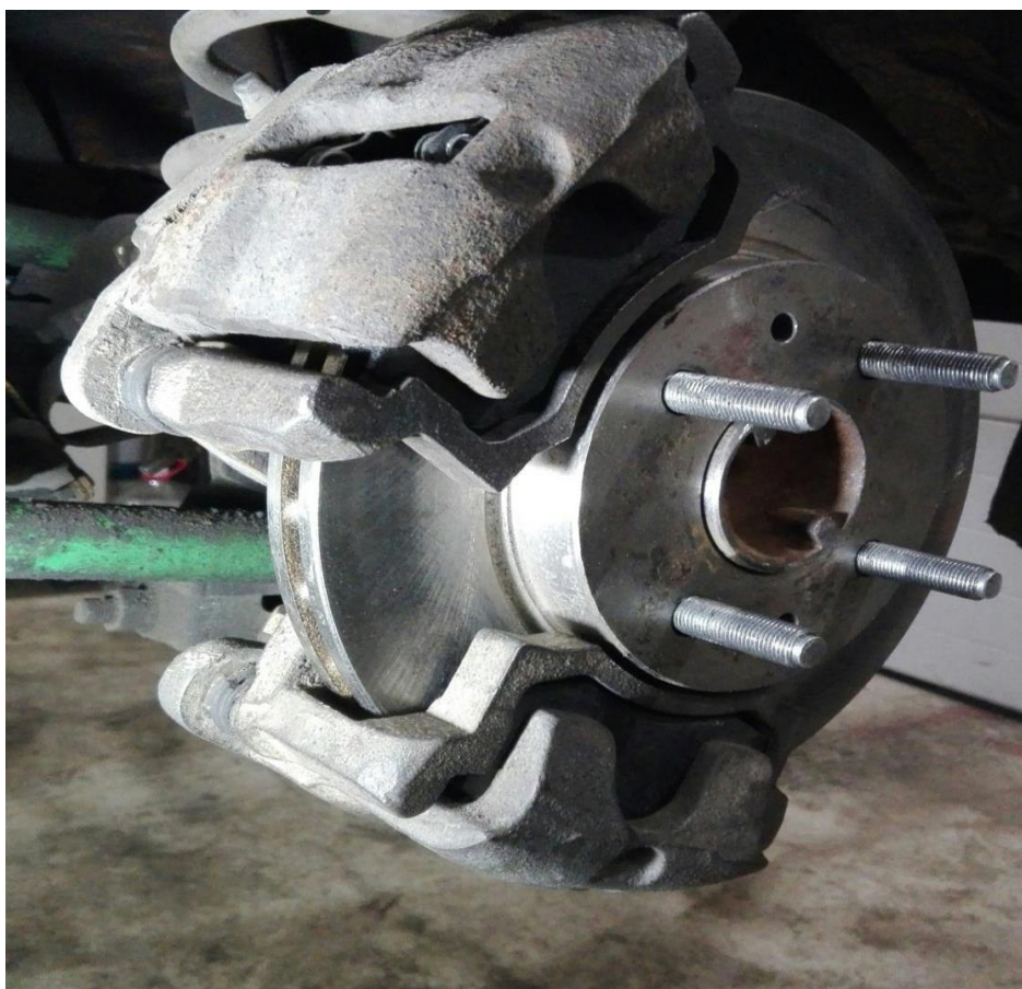
Рисунок 2 – Дополнительный суппорт для подтормаживания буксующего колеса
