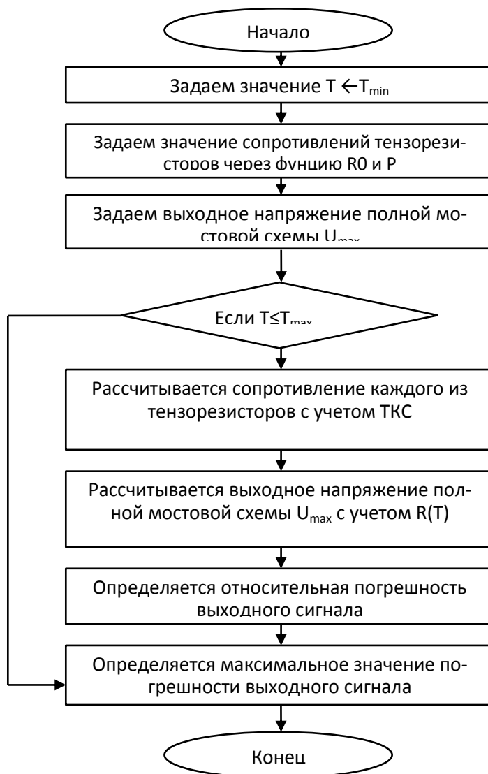
Рисунок 2 – Алгоритм определения максимального значения относительной погрешности выходного сигнала мостовой схемы
