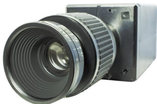
Рисунок 3 – Фотоприемное устройство на основе ГФП ультрафиолетового солнечно-слепого диапазона разработки АО ЦНИИ «Электрон»
