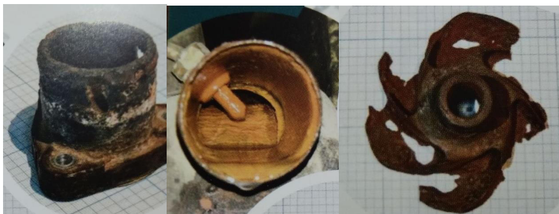
Рисунок 1 – Примеры разрушения деталей системы охлаждения
