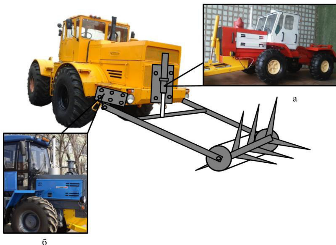
Рисунок 2 – Крепление фронтального прокалывателя-щелереза к колесному полурамному трактору К-700 (К-701) вторым способом:
