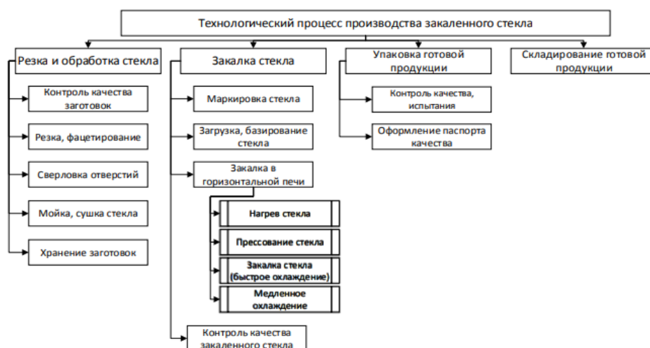
Рисунок 1 – Структурная схема технологического процесса закалки стекла
