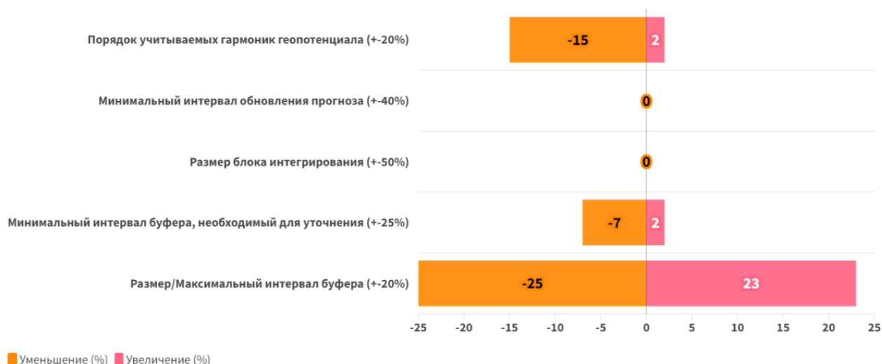
Рисунок 2 – Зависимость точности расчёта от значения параметров
