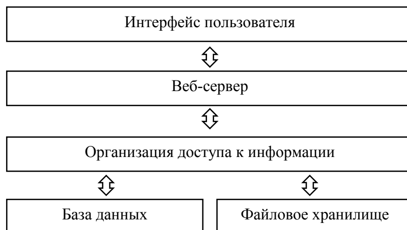
Рис.1. Общая схема архитектуры CMS
