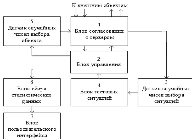
Рис. 3. Структурная схема устройства сетевого контроля деятельности операторов досмотровой техники
