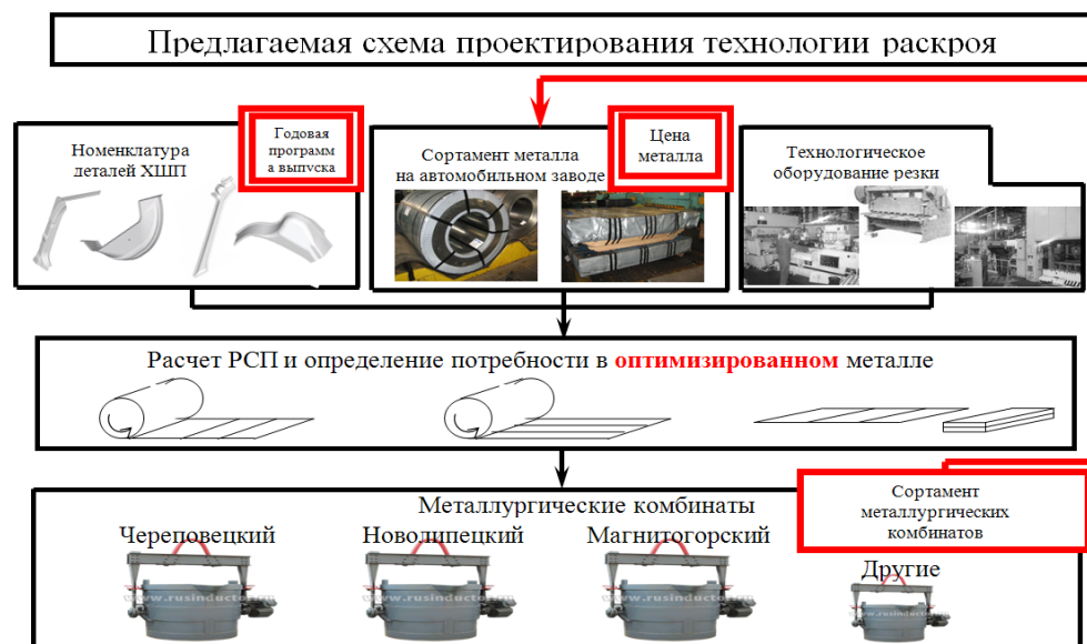
Рис. 4. Предлагаемая схема проектирования раскроя
