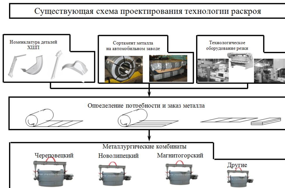
Рис. 2. Существующая схема проектирования раскроя
