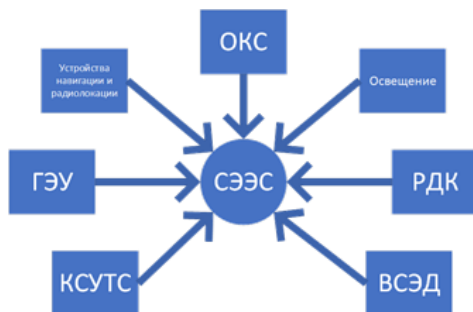
Рис. 1 Структурная схема взаимосвязи СЭЭС с основными системами судна [4]
