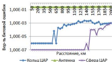
Рис. 2. Вероятность битовой ошибки полезного сигнала на фоне помехи с шумом
