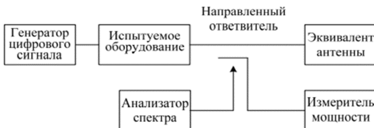
Рис. 1. Структурная схема для измерения выходной мощности и стабильности частоты передающего тракта ЗС
