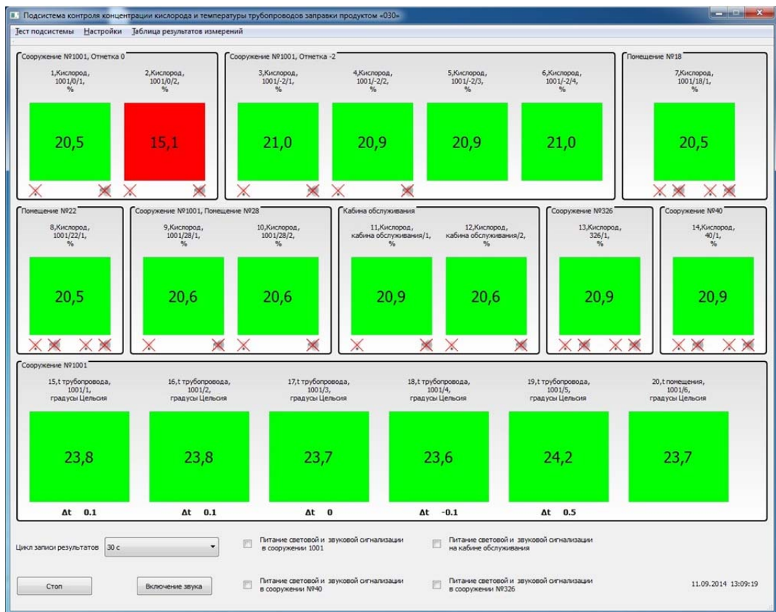
Рис. 2. Экранная форма программного обеспечения контроля процентного содержания кислорода и температуры трубопроводов с пероксидом водорода
