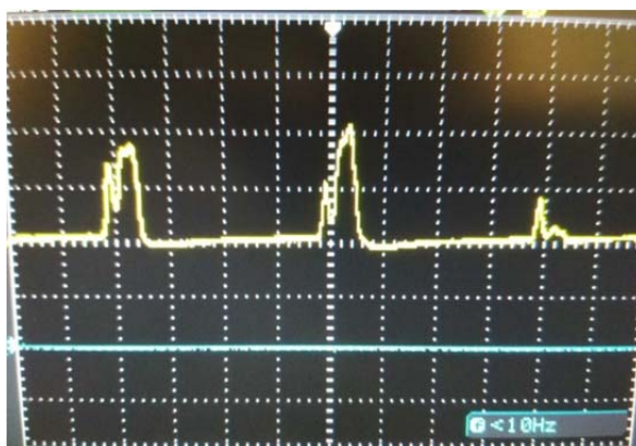
Рис. 3. Напряжение на коллекторе транзистора t_1 (электрод датчика на границе факела)
