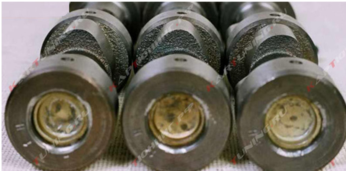
Рисунок 1 - Слева направо: классический, тюнингованный, спортивный распределительные валы
