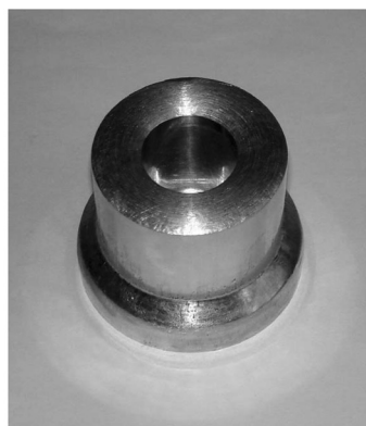
Рис. 32. Выдавленный образец из алюминиевого сплава АД1
