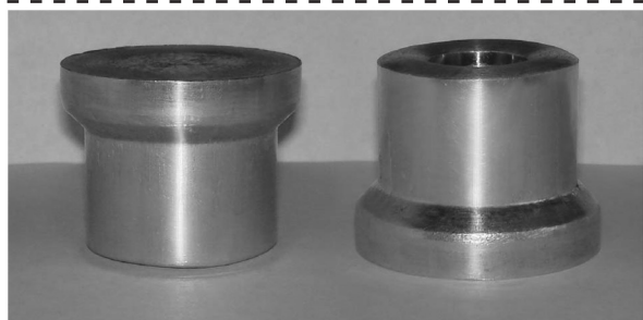
Рис. 31. Выдавленные образцы из алюминиевого сплава АД1
