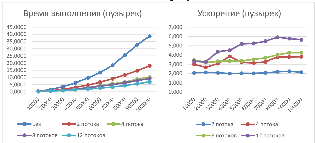
Рис. 1. Зависимость времени выполнения и ускорения от размера массива при выполнении параллельного алгоритма пузырьковой сортировки
