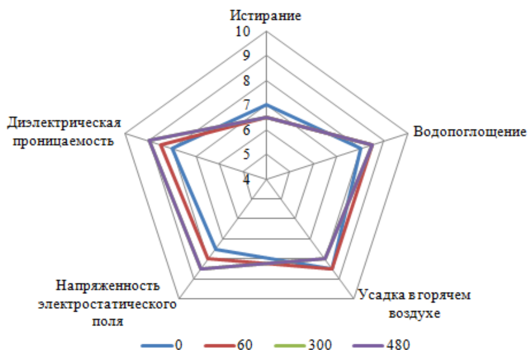
Рис. 4. Сравнительные характеристики образцов Лаке до и после УФ излучения
