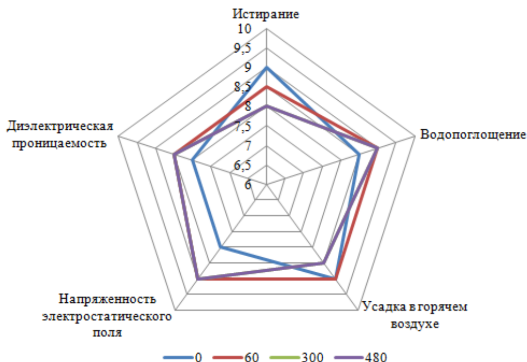
Рис. 4. Сравнительные характеристики образцов Лакоткани до и после УФ излучения
