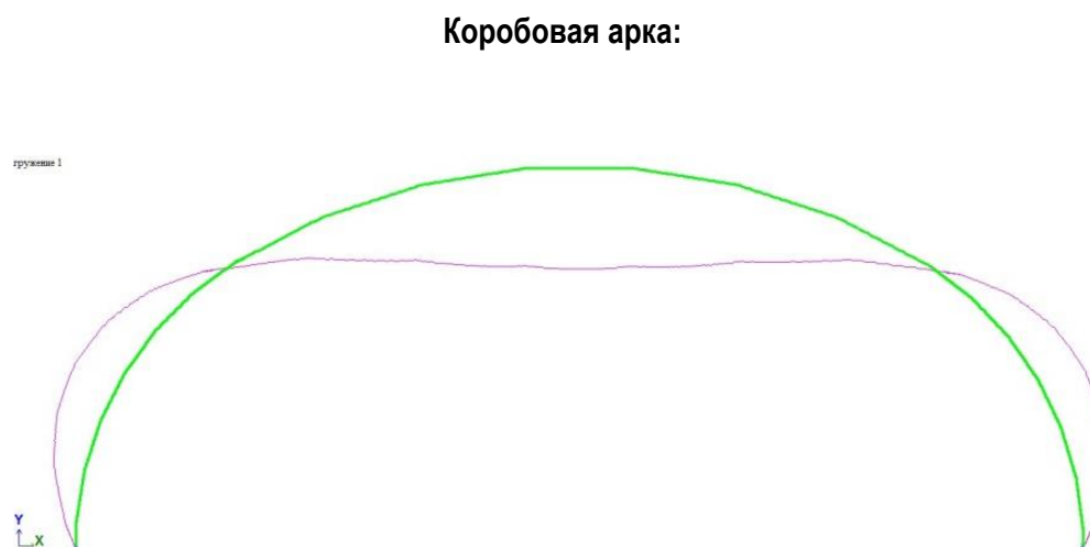
Рис. 8. Эпюра изгибающих моментов трехлопастной арки
