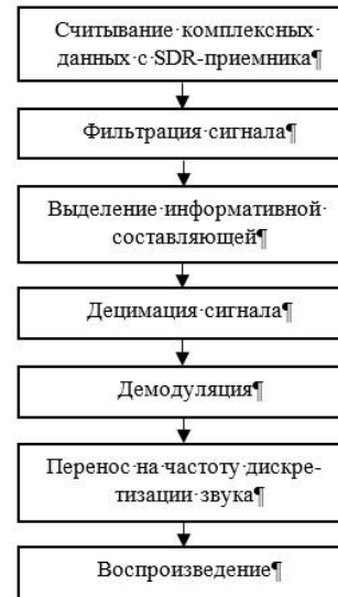
Рисунок 2 – Схема реализации процесса воспроизведения частотно-модулированного сигнала
