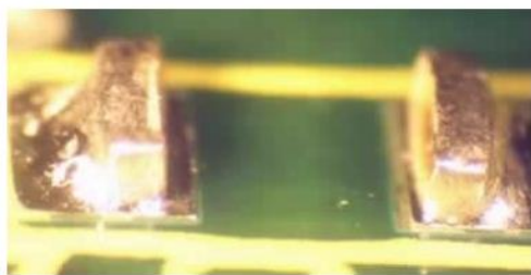
Рисунок 2 – Прошедший в результате растрескивания керамики SMD конденсатор
