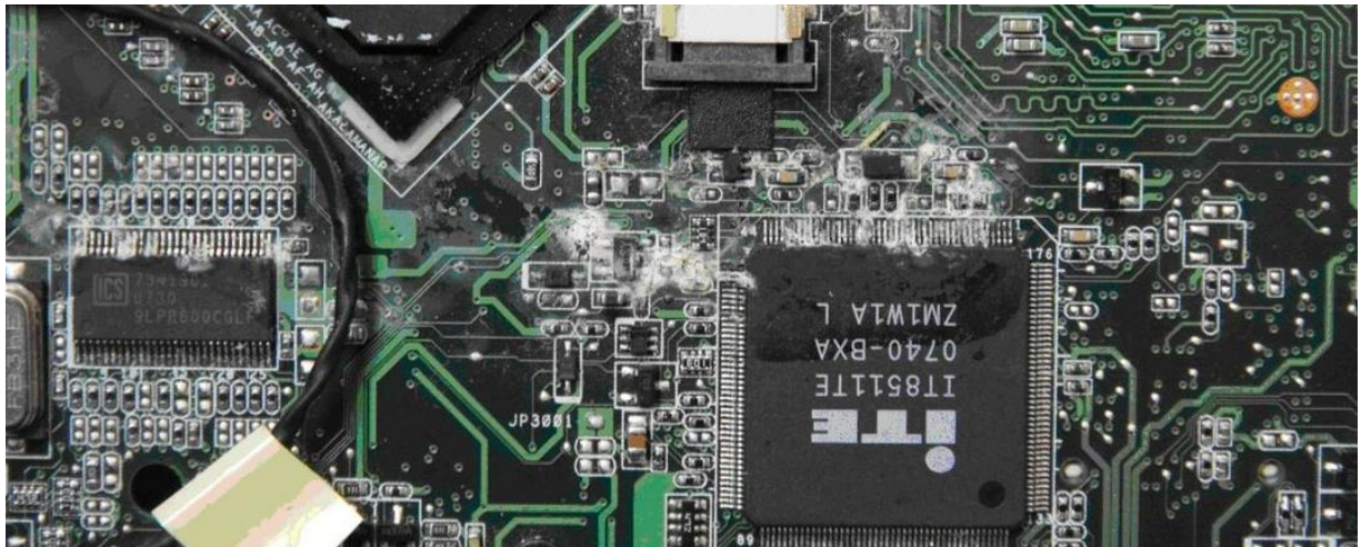
Рисунок 6 – Следы коррозии на печатной плате
