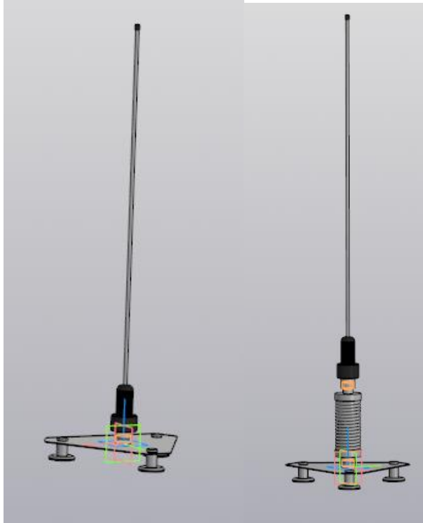
а) антенна с излучателем на магнитном основании; б) антенна с пружинным блоком Рисунок 3 – Конструктивные варианты автомобильных антенн
