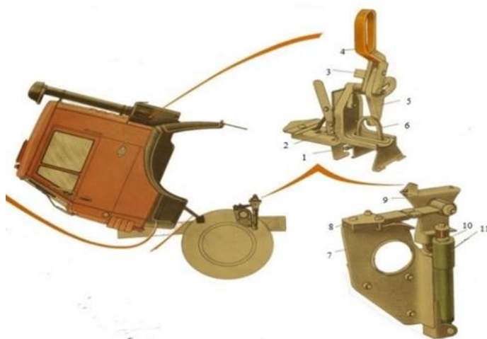
Рисунок 1 – Конструкция подвески кабины
