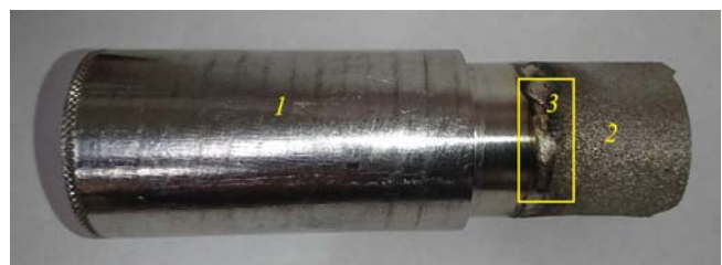
Рис. 1. Исходное изделие: 1 – сталь 12Х18Н10Т, произведенная по традиционной технологии; 2 – Inconel 718 , созданный по технологии SLM ; 3 – исследуемая зона сварного соединения
