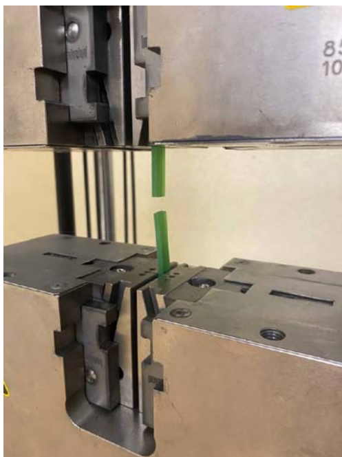
Рис. 4. Разрушенный образец в тисках испытательной машины
