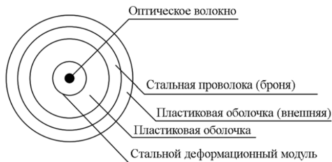
Рис. 2. Деформационный оптоволоконный кабель с одним чувствительным волокном
