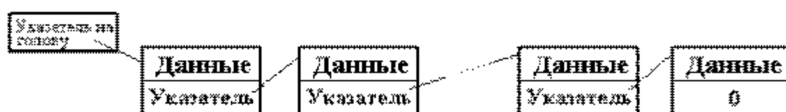
Рис. 2. Логическая структура односвязного списка
