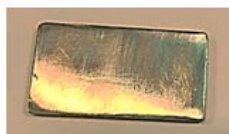
Рис. 1. Экспериментальный образец из стали 40X для лазерной закалки
