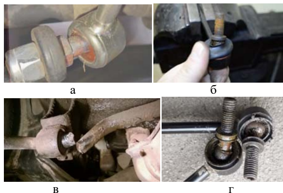
Рис. 2. Результаты износа и разрушения элементов стойки стабилизатора поперечной устойчивости автомобиля: а, б, в – шарового пальца; г – шарнира
