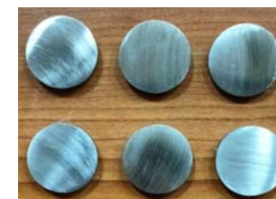
Рис. 2. Экспериментальные образцы из стали 30ХГСА после проведения подготовки поверхности
