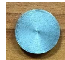
Рис. 1. Экспериментальный образец из стали 30ХГСА до предварительной обработки поверхности
