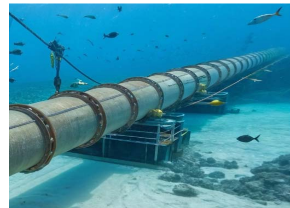
Рис. 2 Платформа для подводного трубопровода. [5]
